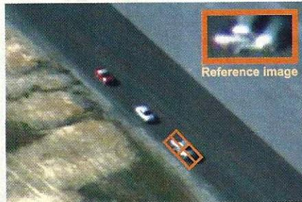
Robocortex travaille sur l'analyse d'image pour la vision robotique, comme l'estimation de la position d'un véhicule en mouvement.
